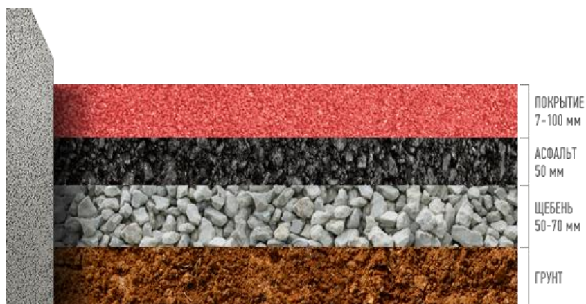
Рис. 3 – Подготовка основания для укладки резиновой плитки (асфальт).
