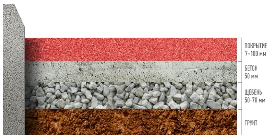
Рис. 2 – Подготовка основания для укладки резиновой плитки (бетон).
