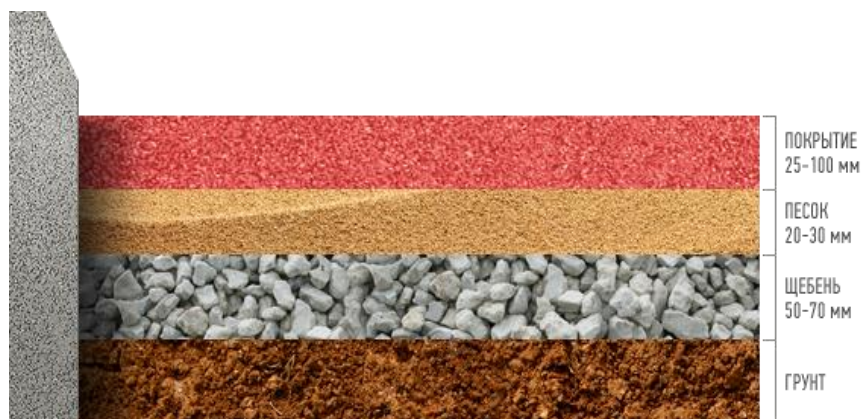
Рис. 1 – Подготовка основания для укладки резиновой плитки (ПГС, отсев от песка).
